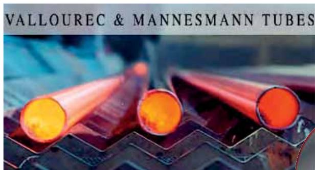
1. Tube formé à chaud sans soudure MSH.
